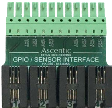
HX-050 GPIO ADAPTER ACTUAL SIZE
